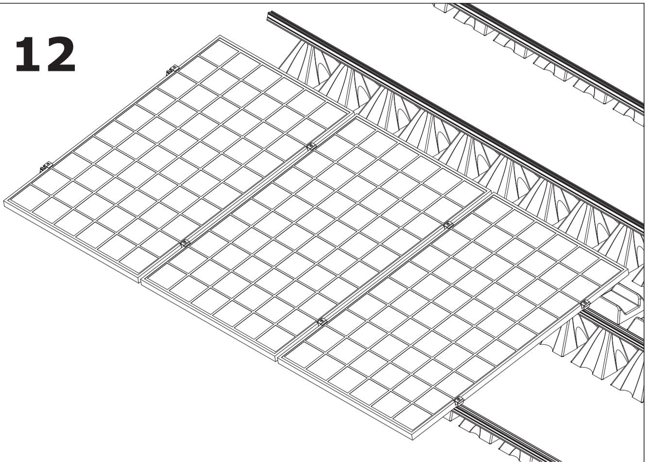
Serrer les modules à l'aide d'une clé dynamométrique - 10Nm
